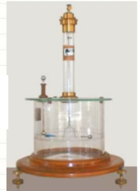
Bilancia a torsione per la verifica della legge di Coulomb
